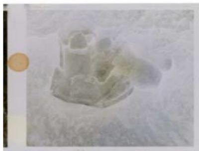
現像処理後9年経過して、ネガフィルムの一部のコマの小さな黄変部分に気付く。その後、3年経過後の観察では全部のコマに明瞭で大きな面積の黄変部分が現れた。この明瞭な残留ハロゲン化銀の反応は、このネガフィルムが極端な定着不足で、数年でネガフィルムの画像のほとんどが消失していくことを示している。
